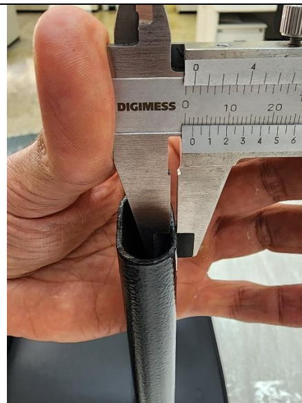
Chapa com espessura mínima de 1,27mm (chapa n.18), acabamento em pintura eletrostática em tinta pó, na cor preta.
