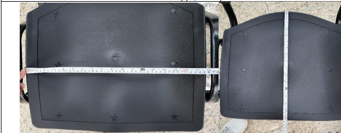
Assento medindo 470x430mm (LxP) *Dimensões dentro de margem aceitável
