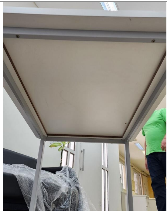
Tampo com 15 mm, reengrossado com mais 15 mm, totalizando 30 mm de espessura. Estrutura em aço carbono, com soldagem em sistema Mig. Fixação do tampo na estrutura por parafusos.
