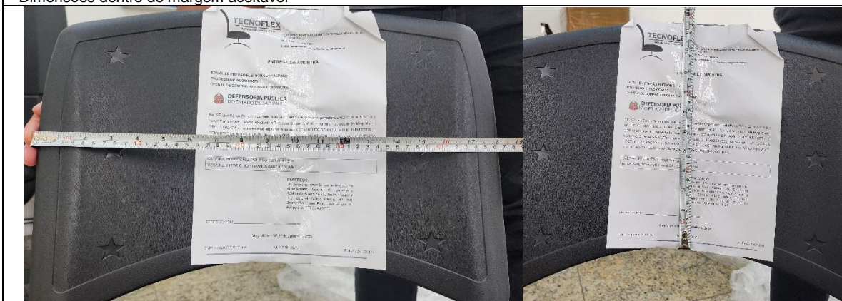
Encosto medindo 470x270mm (LxA) *Dimensões dentro de margem aceitável
