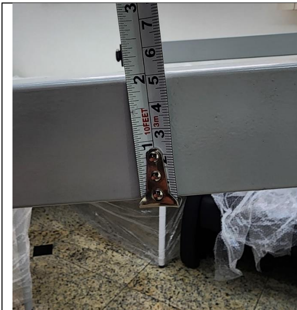
Estrutura formada por tubos de aço carbono de seção retangular 40 x 30 mm.
