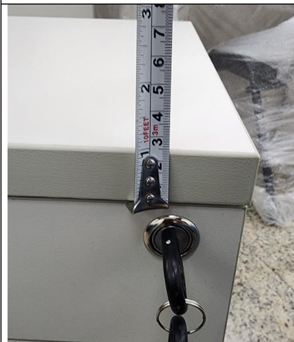
Em madeira MDP, com tratamento antibactericida contra cupim e fungos, espessura mínima de 25mm para o tampo e de 18mm para as laterais, fundo e base; revestido em ambas as faces com laminado melamínico de baixa pressão. Acabamento com fita de borda em PVC na mesma cor do revestimento, colada no sistema hot melt .
