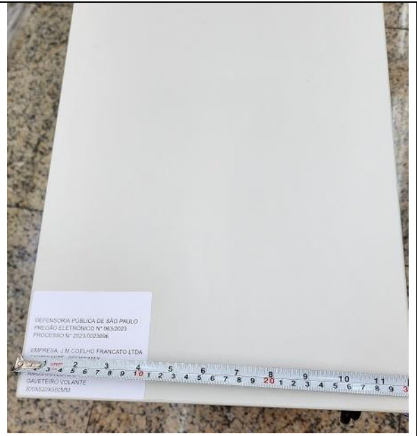
Dimensões: 300(l) x 520(p) x 560(h) mm. Tolerâncias dimensionais: +/- 2%.
