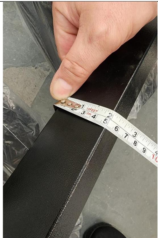
**Base:** estrutura em aço tubular retangular de pés duplos de aproximadamente 30x50mm; chapa com espessura mínima de 1,2mm
