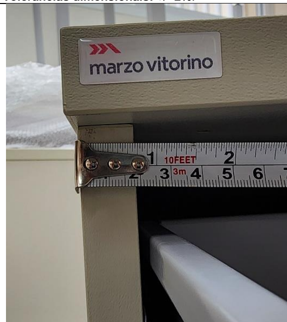
Dimensões: 300(l) x 520(p) x 560(h) mm. Tolerâncias dimensionais: +/- 2%.
