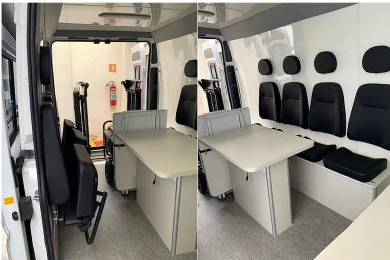
3.3.3. Uma bancada inferior confeccionada em chapas de compensado e fórmica com quatro gavetas e uma porta com abertura frontal:
