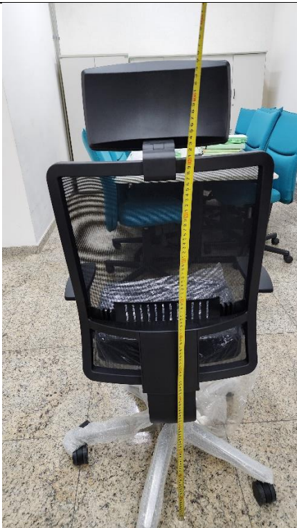
Espaldar: espaldar médio (modelo diretor), medidas 960/1080 x 690 x 690 mm (altura x largura x profundidade)
