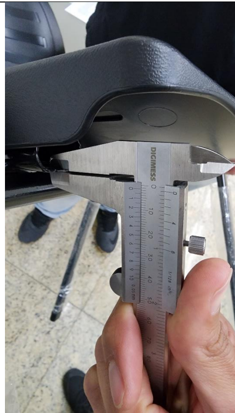
Matéria Prima Estrutura: Em aço tubular; Tipo de Estrutura: Chapa com espessura mínima de 1,5mm;
